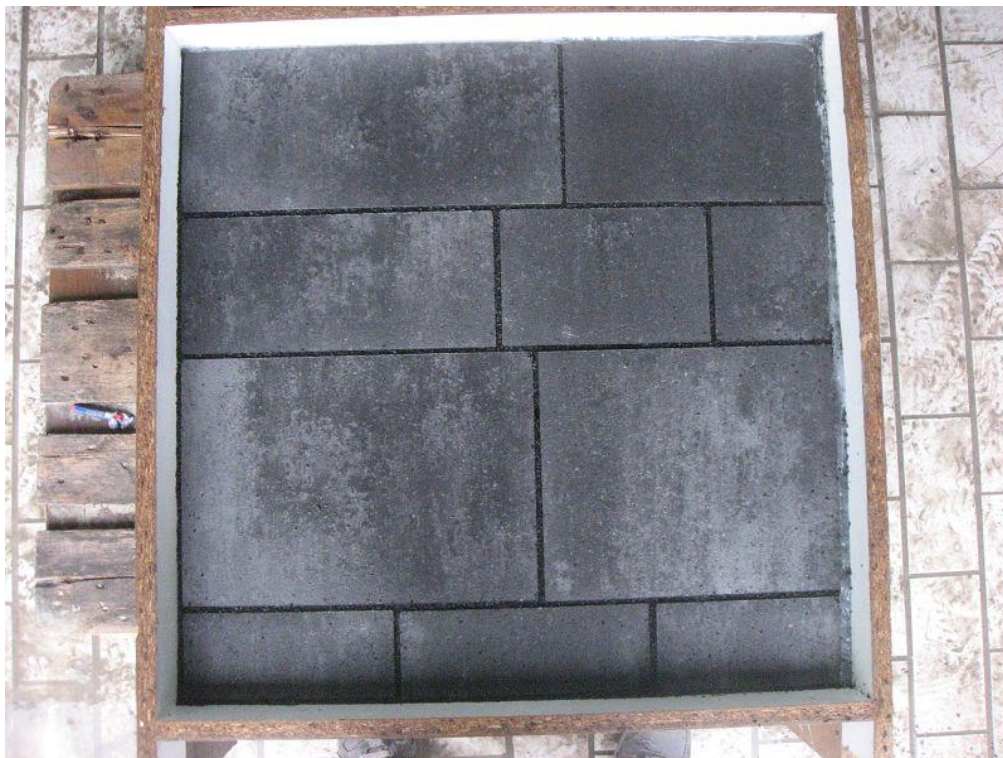
Abbildung 3: Prüffläche mit Fugenverfüllung
